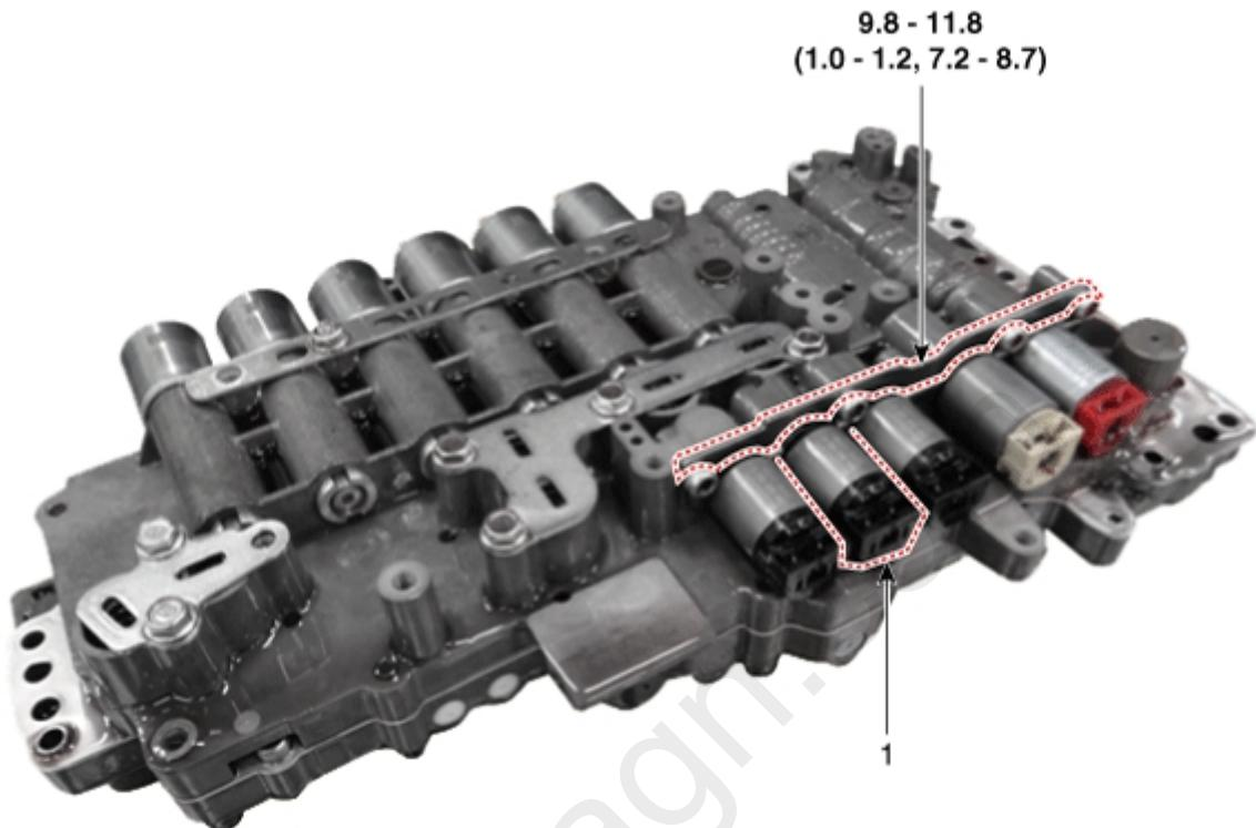
Tightening torque: N·m (kgf·m, lb·ft)
